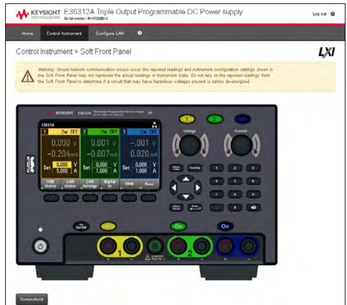
Рис. 6. Управление источником питания при помощи удобного графического интерфейса пользователя, имитирующего лицезубую панель прибора.
